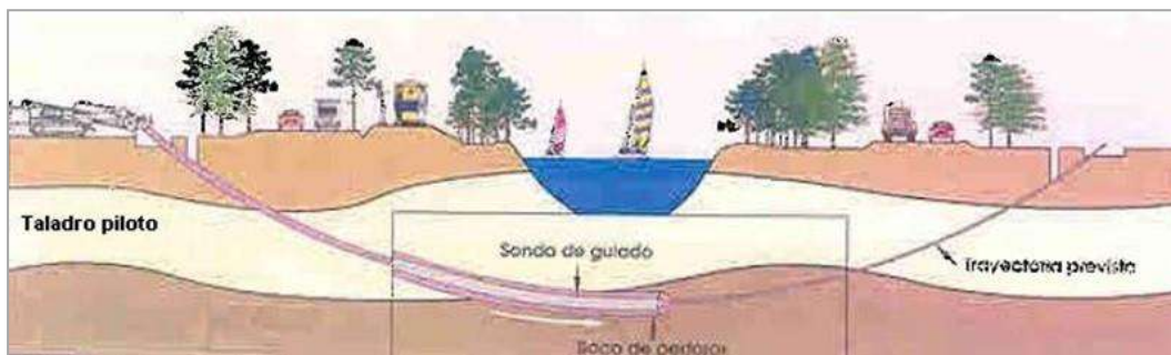
Figura 11. Detalle de perforación piloto. Fuente: promotor.
