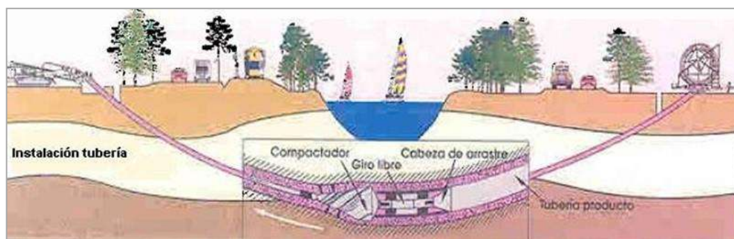
Figura 13. Detalle de instalación de la tubería. Fuente: promotor.
